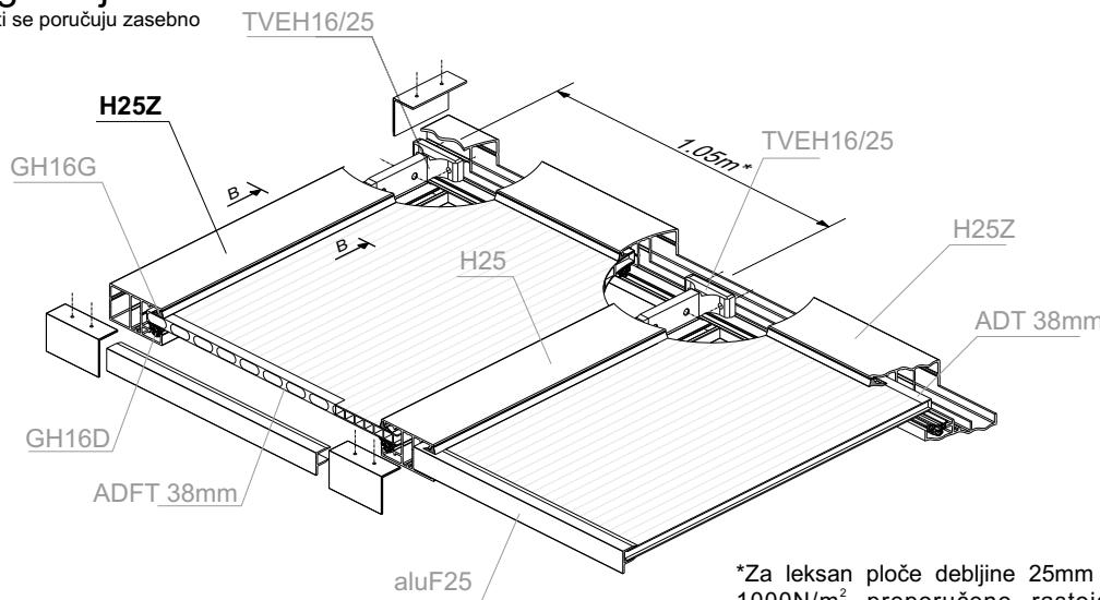
\*Za leksan ploče debljine 25mm i opterećenje 1000N/m<sup>2</sup> preporučeno rastojanje između Hermitage H10 profila d=1.05m (rastojanje između rožnjača L ≤ 2.5m).
