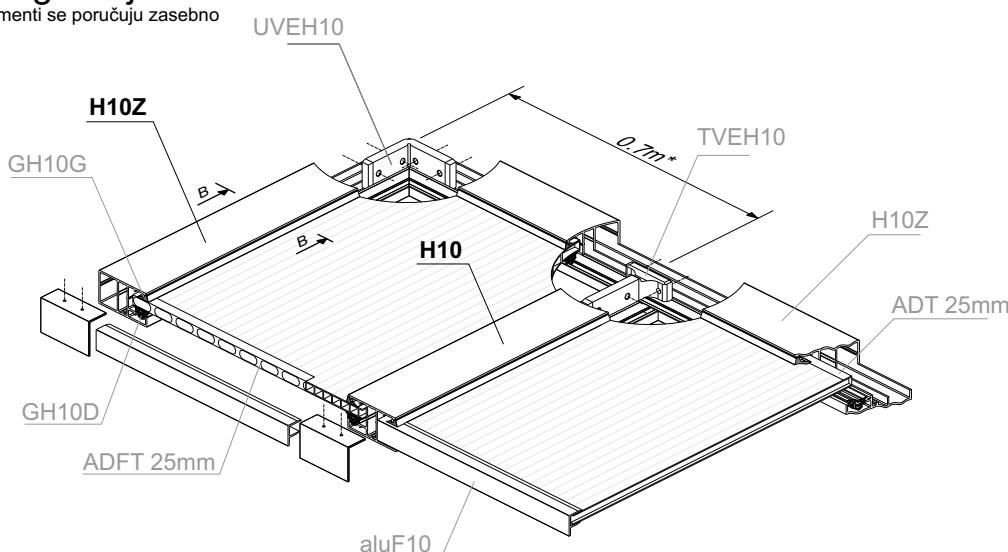
\*Za leksan ploče debljine 10mm i opterećenje 1000N/m<sup>2</sup> preporučeno rastojanje između Hermitage H10 profila d=0.7m (rastojanje između rožnjača L≤2m).
