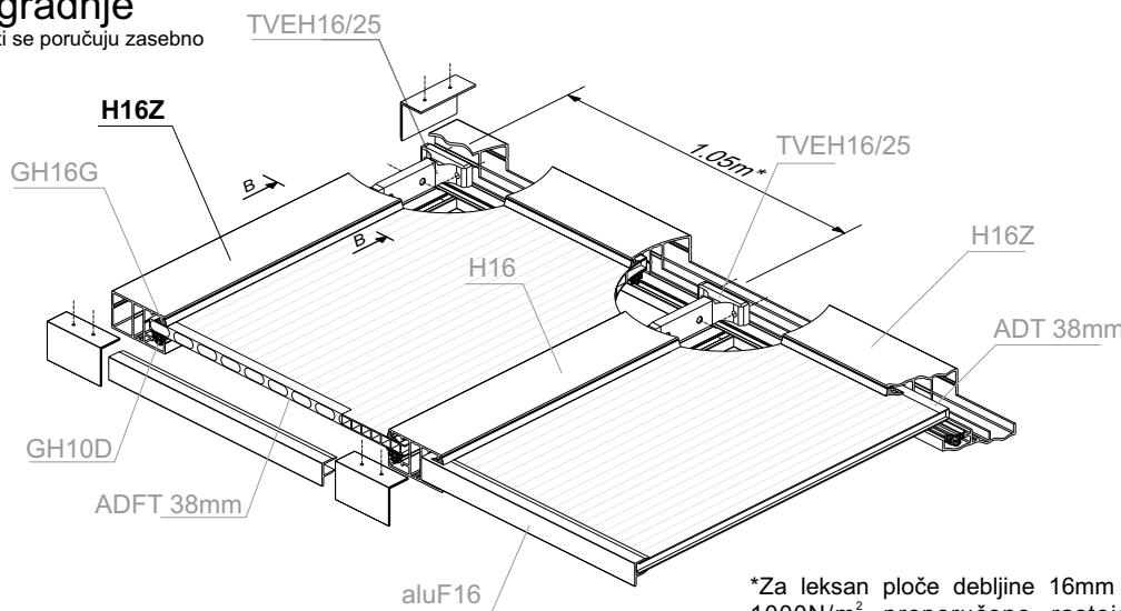
\*Za leksan ploče debljine 16mm i opterećenje 1000N/m<sup>2</sup> preporučeno rastojanje između Hermitage H10 profila d=1.05m (rastojanje između rožnjača L ≤ 2.5m).
