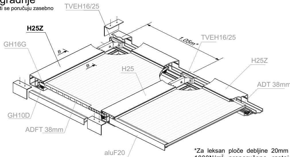
\*Za leksan ploče debljine 20mm i opterećenje 1000N/m<sup>2</sup> preporučeno rastojanje između Hermitage H10 profila d=1.05m (rastojanje između rožnjača L ≤ 2.5m).
